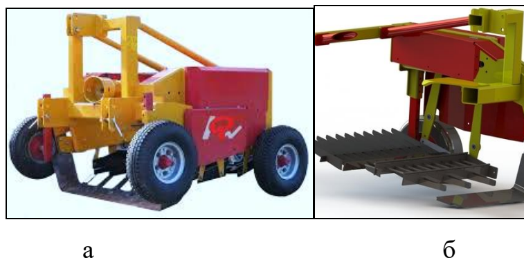
Рисунок 3 – Загальний вигляд (а) та викопувально-струшувальний пристрій (б) виорювача саджанців ROBOT BL900S
