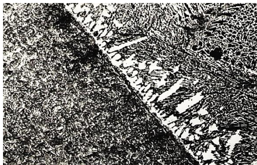
Рисунок 3 – Мікроструктура крапкового покриття на сталі 65Г, х320
