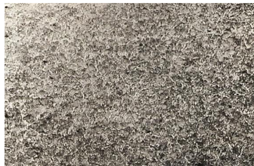
Рисунок 4 – Мікроструктура покриття зі сплаву ПГ-С27, ПГ-С27, Х320
