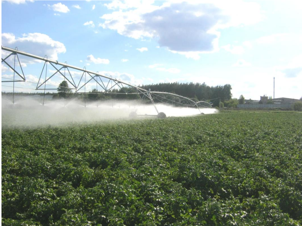
Рис. 2 Загальний вигляд дощувальної ферми в роботі
