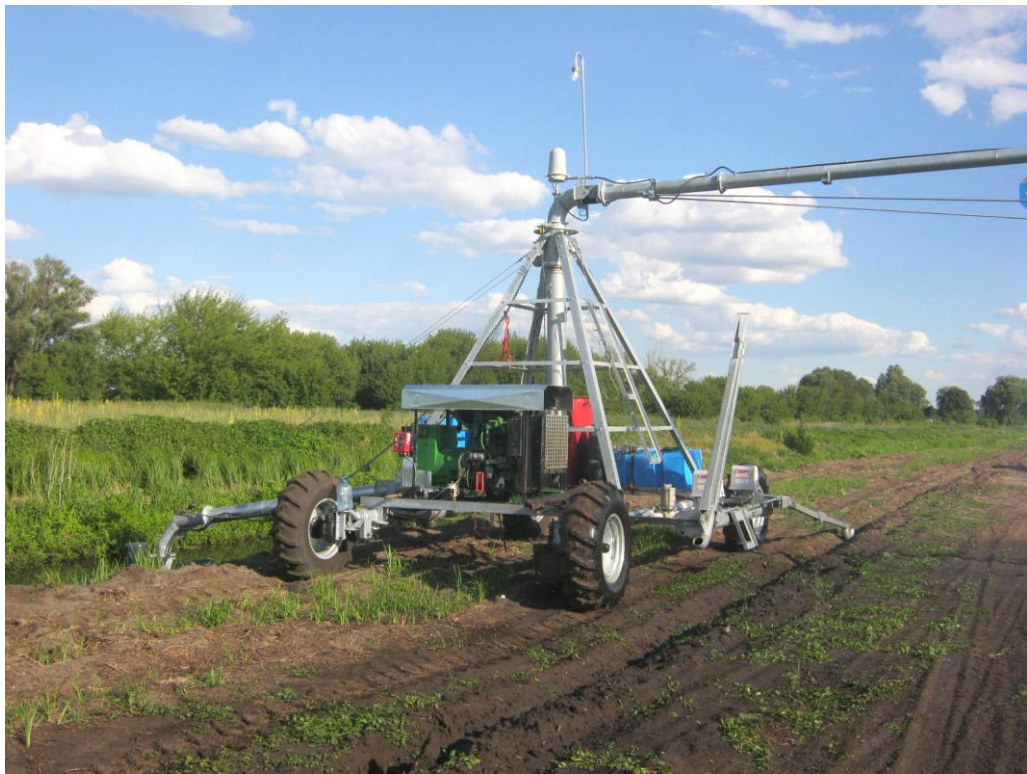
Рис. 1 Загальний вигляд силового візка дощувальної машини UHFLSA 2x185x1670
