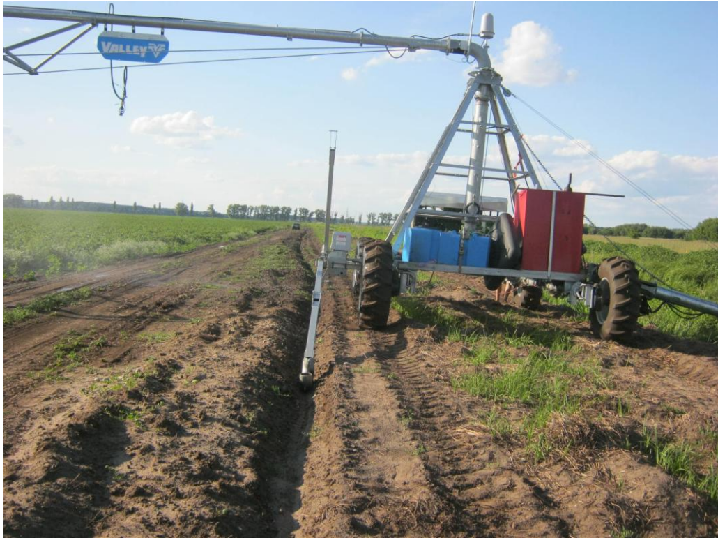
Рис. 6 Управління рухом дощувальної машини по борозні паралельно каналу
