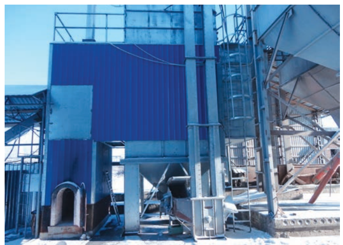
Рисунок 7 – Мала топка теплогенератора (на фото – зліва, в нижній частині) за технічними параметрами і теплопродуктивністю явно не узгоджується з продуктивністю шахтної сушарки (на фото – справа)
