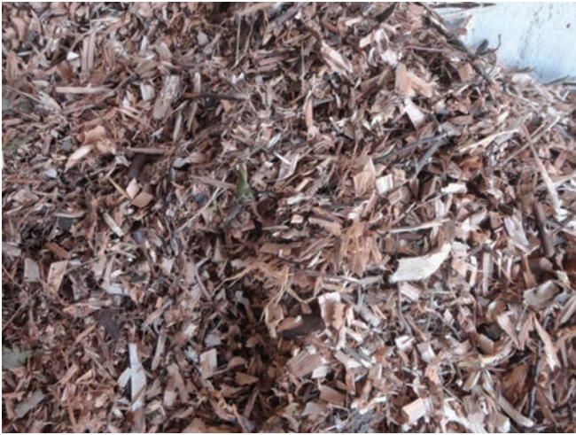
Рисунок 6 – Тріски твердих порід дерев, готові до спалювання в теплогенераторі (загальний вигляд)
