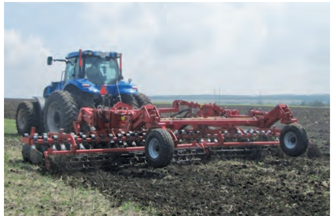
Рисунок 2 – Виконання технологічного процесу ґрунтообробки агрегатом трактор «New Holland T8.390» + агрегат ґрунтообробний «ДЛМ-8» у ході випробувань
