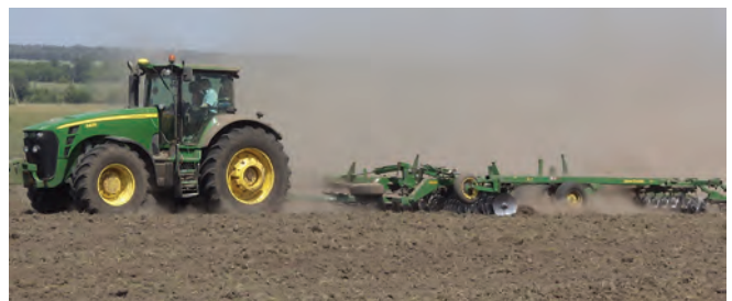
Рисунок 2 – Комбінований ґрунтообробний агрегат на базі трактора «John Deere 8430» і дискової борони «John Deere 637»
