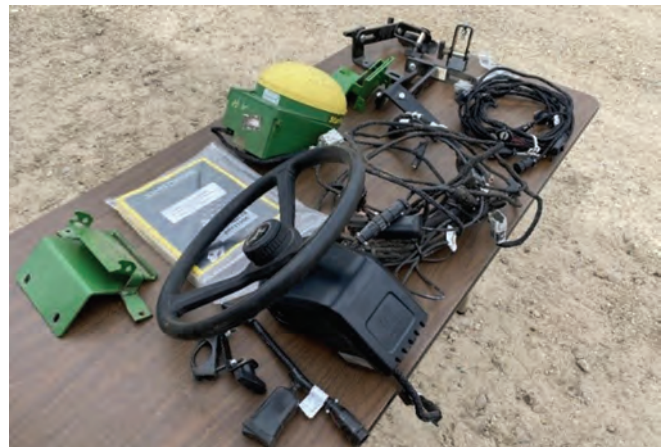
Рисунок 2 – Конфігурація обладнання «John Deere AutoTrac»
