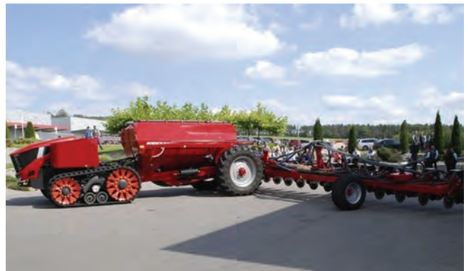
Рисунок 6 – Робот «RO1» з 24-рядною сівалкою «Maestro»
