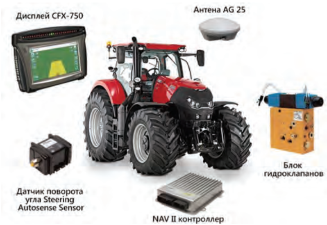
Рисунок 1 – Конфігурація обладнання «Trimble Autopilot»
