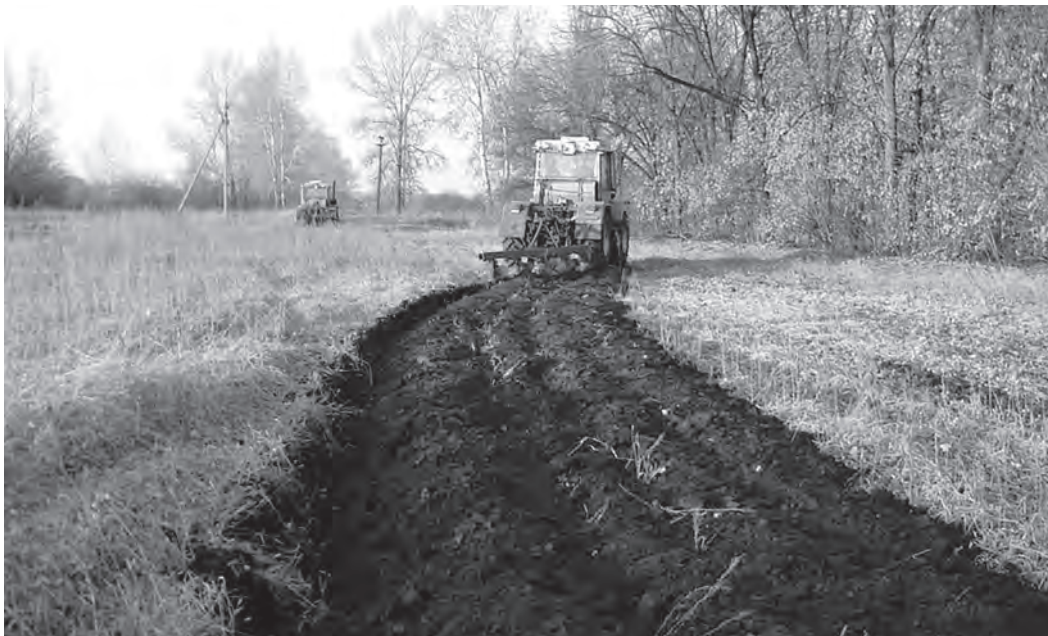
Рисунок 1 – Відведення трактора «ХТЗ-17221» на орних роботах від прямолінійного руху без впливу тракториста на рульове колесо
