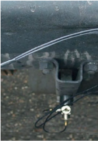
Рисунок 6 – Монтаж вібродатчика на рамі з лівого боку (проти-лежного розташуванню глушника та випускно-го колектора двигуна)
