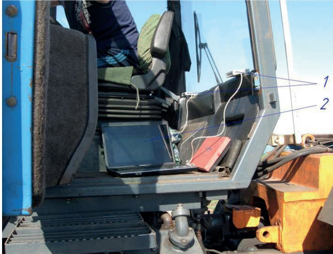
1 – ЕОМ для зняття та архівації даних; 2 – датчики прискорень
