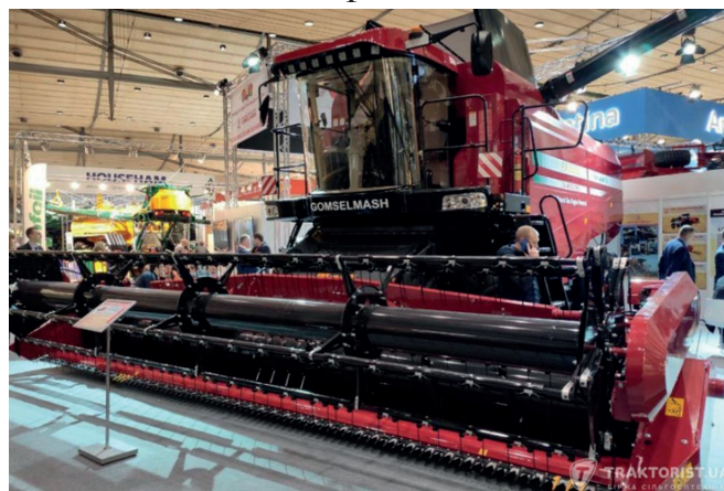
Рисунок 13 - Зернозбиральний комбайн Palesse GS4218 CNG виробництва «ГОМСЕЛЬМАШ» з метановим двигуном (Міжнародна виставка Agrotechnika 2019, м. Ганновер)
