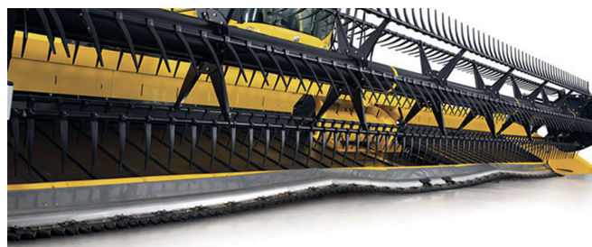
Рисунок 7 - Зернова жатка Superflax із гнучким різальним апаратом компанії «NEW HOLLAND» [20]
