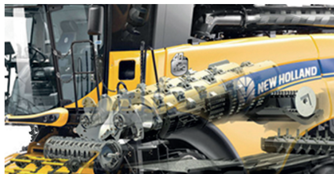
Рисунок 10 - Двороторний молотильно-сепарувальний пристрій Twin Rotor зернозбиральних комбайнів компанії «NEW HOLLAND» [20]
