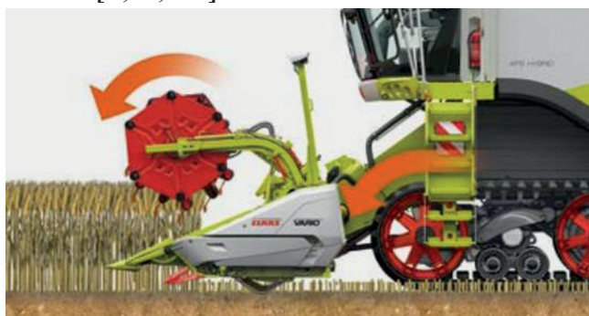
Рисунок 3 - Система синхронізації частоти обертання мотовила і швидкості руху зернозбирального комбайна [19]
