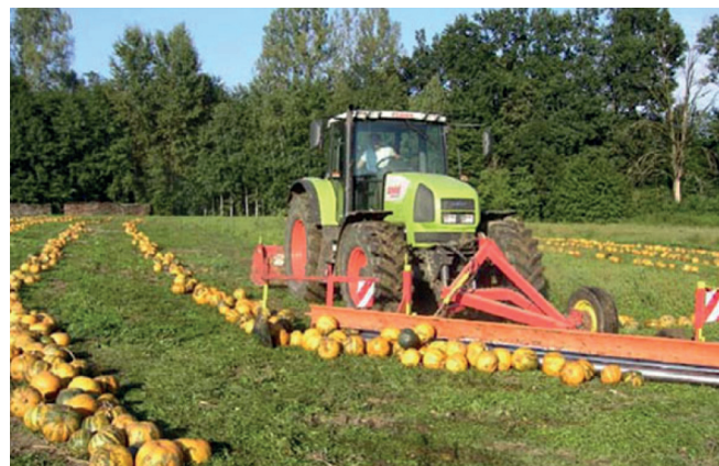
Рисунок 2 – Валкоутворювач плодів гарбуза марки «MOTY» («Kröpfel Landmaschinen GmbH», Австрія)
