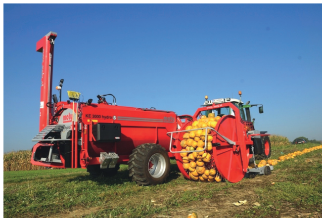
Рисунок 7 – Комбайн для збирання плодів гарбуза та виділення насіння марки «MOTY» («Kröpfel Landmaschinen GmbH», Австрія)
