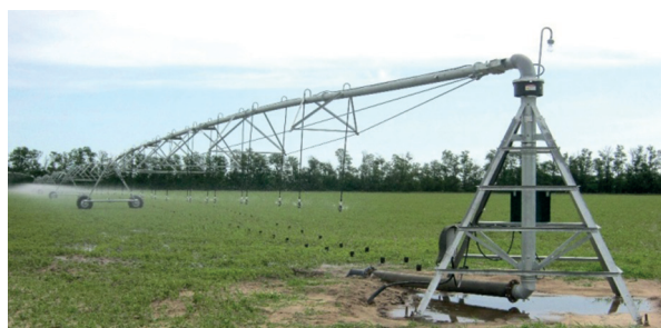
Рисунок 4.4 – Дощувальна машина кругової дії марки «Zimmatic»
