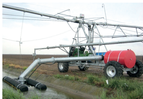
Рисунок 4.3 – Загальний вигляд силового візка дощувальної машини із забором води з каналу марки «Valley»
