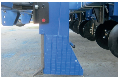
Загальний вигляд трубоукладального ножа
