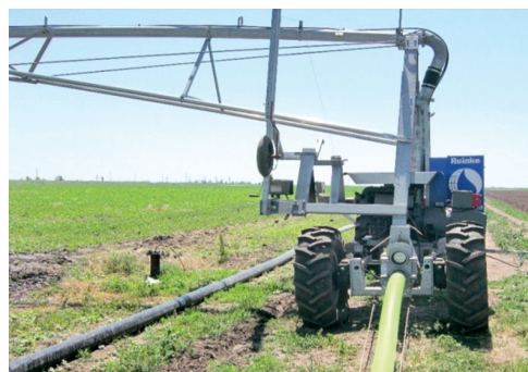
Рисунок 4.2 – Загальний вигляд силового візка дощувальної машини з забором води шлангом від гідрантів марки «Reinke»
