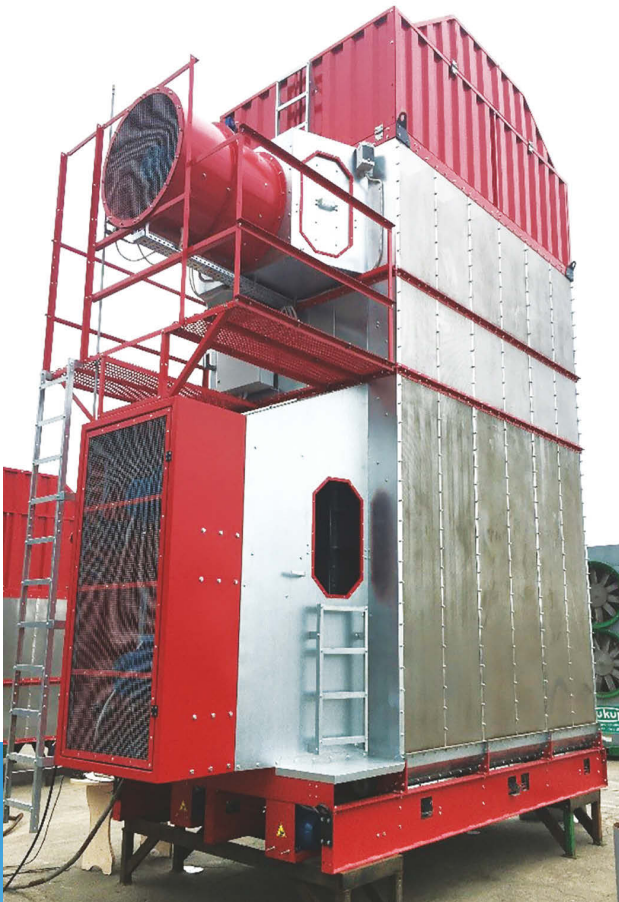
Рисунок 5 – Зерносушильні модулі «ЗСК-04», змонтовані на тестувальному майданчику ТОВ «Фенікс Технолоджи»
