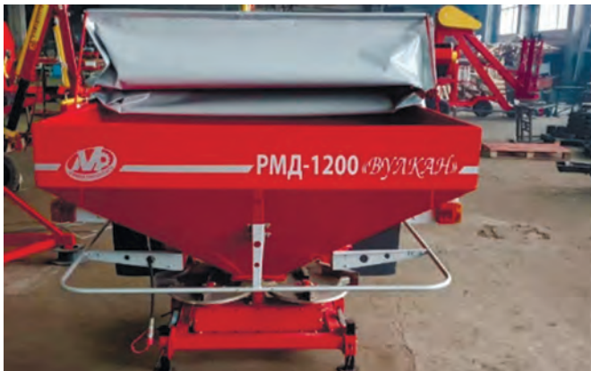
Рис. 7 – Розкидач мінеральних добрив РМД-1200 "ВУЛКАН"
