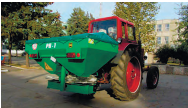
Рис. 8 – Розкидач мінеральних добрив РН-1
