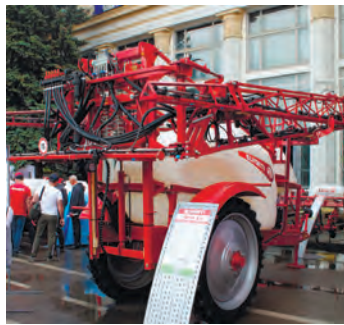
Рис. 15 – Причіпний обприскувач TETIS 24
