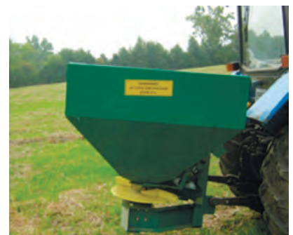
Рис. 5 – Розкидач мінеральних добрив МВД-1000
