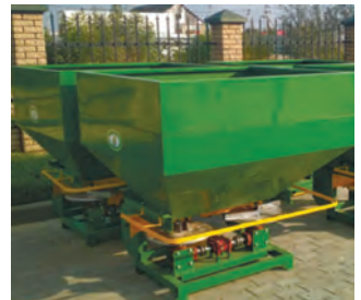
Рис. 4 – Розкидач мінеральних добрив РД-1000
