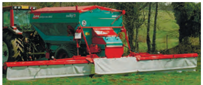
Рис. 10 – Шнековий розподілювач Sulky DPA POLIVRAC
