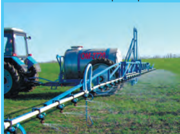
Робота насосного агрегата у складі обприскувача ОМ-2720
