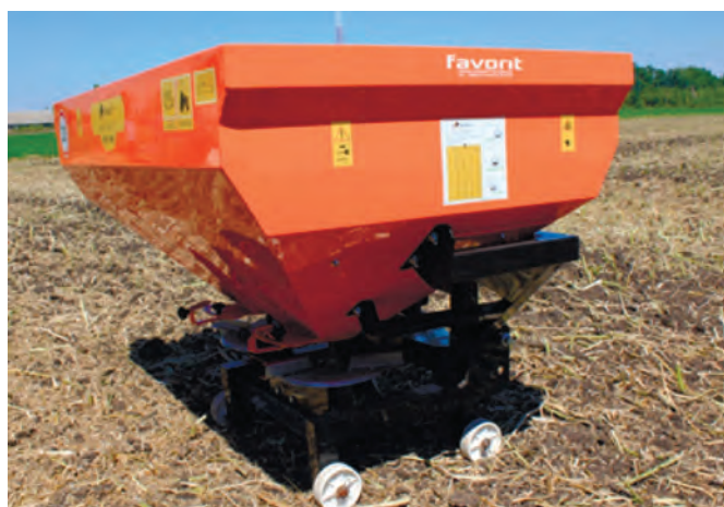
Рис. 1 – Розкидач мінеральних добрив РДФ-1000
