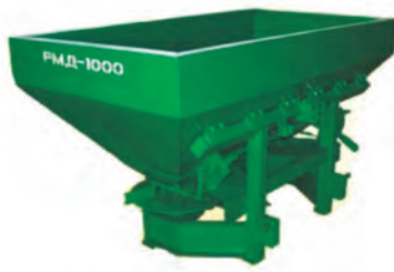
Рис. 6 – Розкидач мінеральних добрив РМД-1000
