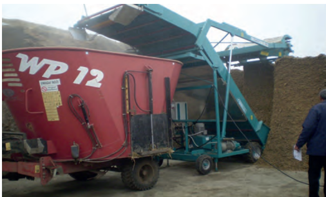
Рис. 14 — Самохідний нарізувач-завантажувач силосних мас серії TAURUS
