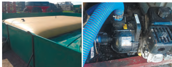
Рис. 3 – Обладнання для зберігання КАС та закачування рідини в аплікатор: а - гнучкий резервуар; б - насос
