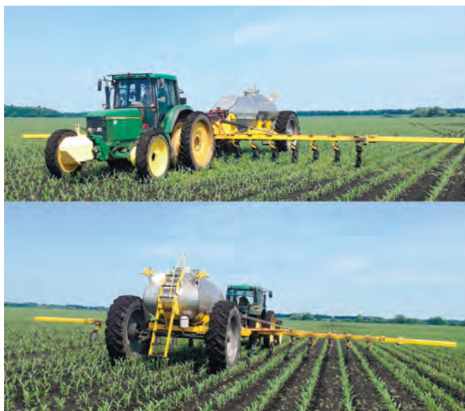
Рис. 4 – DRAGON-6000 в роботі під час міжрядного внесення КАС на посівах кукурудзи
