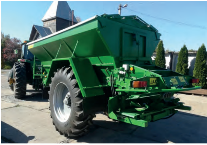
Рис. 7 — Розкидач мінеральних добрив BIM GKE 7000 збільшується об'єм бункера з 1500 л до 2000 л [3]. У роботі розкидача мінеральних добрив BIM GKE 7000 слід відзначити таке:
