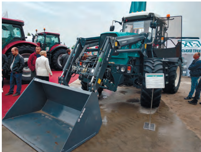
Рис. 5 – Трактор ХТЗ-160У з встановленим фронтальним навантажувачем Metal Fach T229 («ЯР-Степ»)
